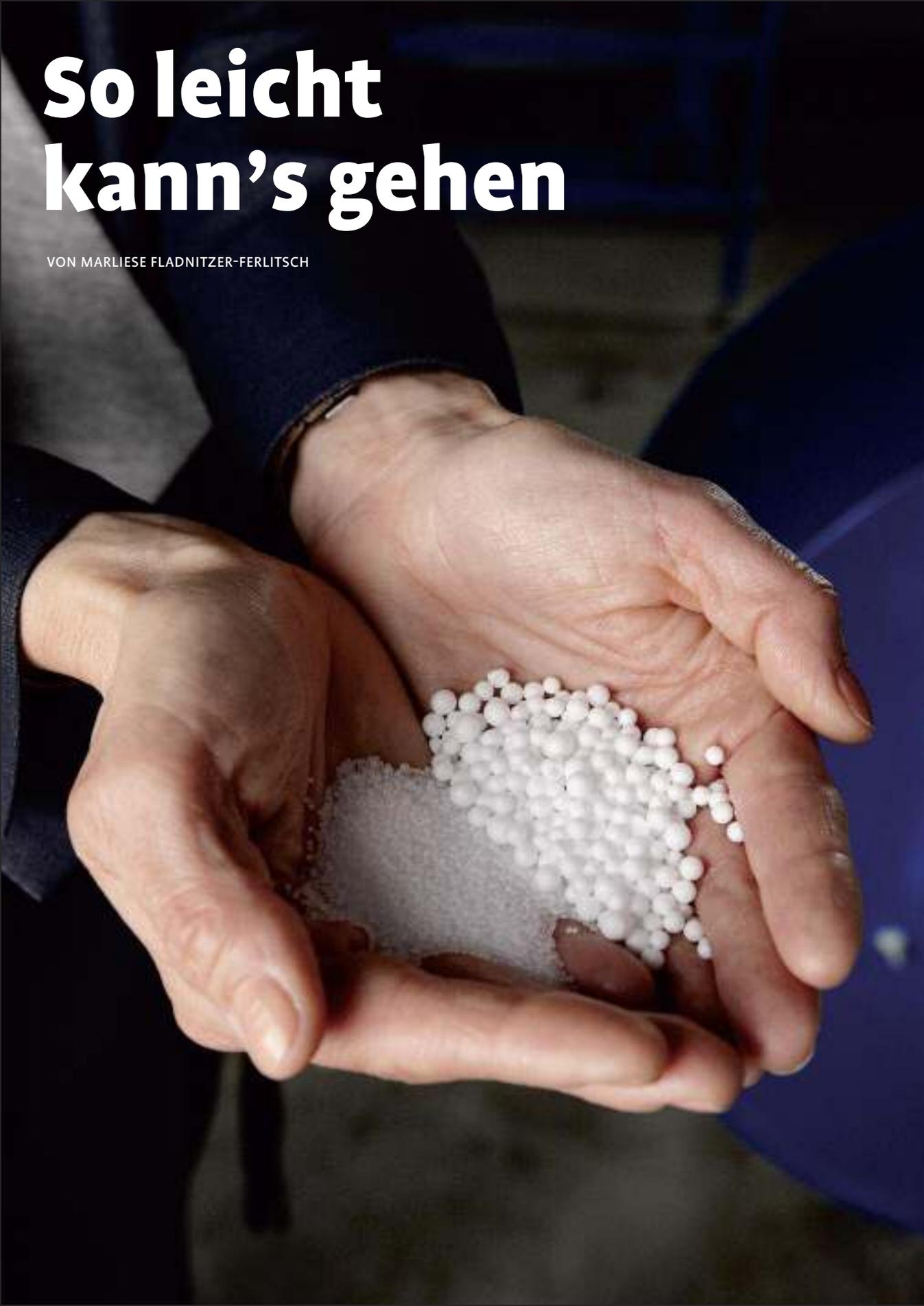
Bei der HIRSCH Servo Gruppe dreht sich alles um den leichten und vielseitig einsetzbaren Werkstoff EPS – expandierbares Polystyrol.
