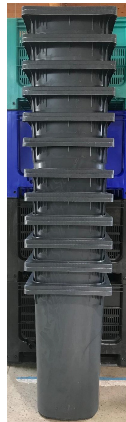
Die Recyclingmülltonnen halten auch dem Stapeltest problemlos stand. Damit ist ein sicherer Transport von bis zu 13 gestapelten Tonnen möglich. Bild: EUROPLAST
